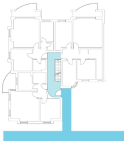
9 Erdgeschoss-Grundriss eines Wohngebäudes, Dreispanners
